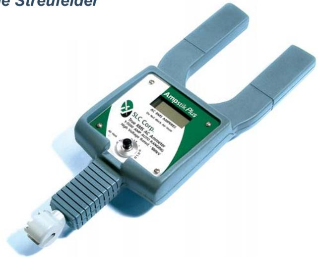
Das Funktionsprinzip des AmpstikPlus basiert auf einem induktiven Sensor. Somit kommen keine magnetischen Materialien oder bewegende Komponenten zum Einsatz. Das Gerät kann die Ergebnisse von bis zu vier verschiedenen TRMS Strommessungen automatisch nacheinander speichern. Daher muß das Ergebnis nicht nach jeder einzelnen Messung abgelesen werden.
